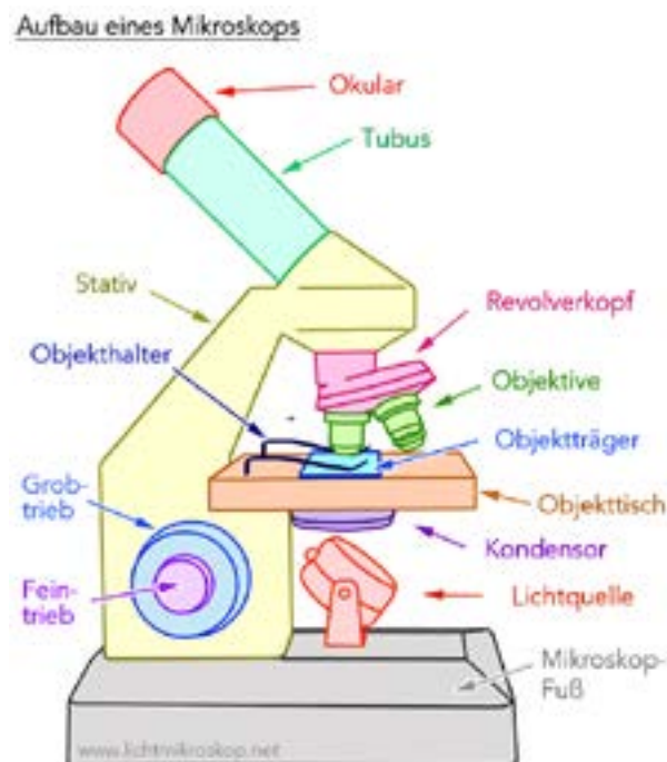
Abbildung 2: Funktionsweise eines einfachen Lichtmikroskops [6].
